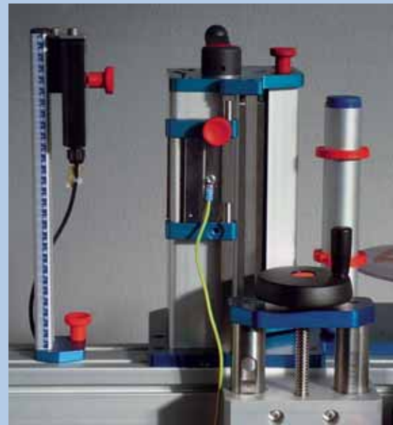
Gruppo fotostop e freno antistatico. Photo-stop unit with antistatic brake. Senseur photostop et freine antistatique.
