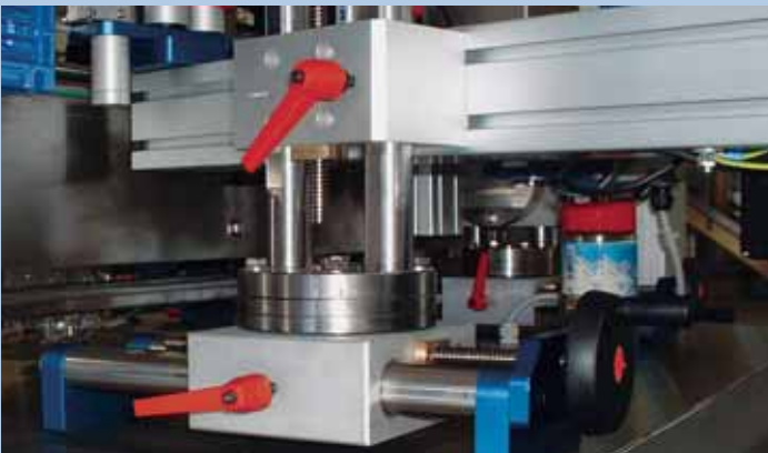
Regolazione gruppi etichettaggio con sistema a 3 assi. Regulation of labelling units with 3 axes adjustment. Régulation unité d'étiquetage avec système à 3 axes.
