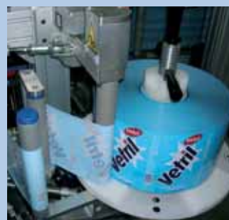
Portabobina con rulli antiaderenti. Reel holder with nonstick rollers. Porte bobine avec rouleaux anti-collants.
