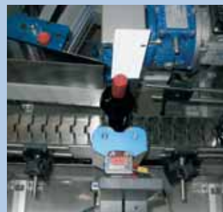
Sistema di rotazione elettro pneumatico. Electro - Pneumatic rotation system. Système de rotation electro - pneumatique.
