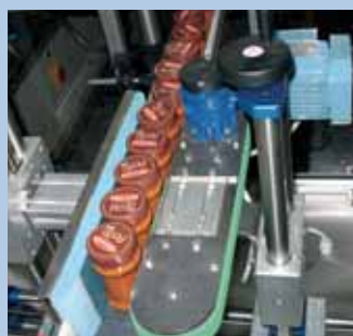
Sistema distanziatore dei contenitori Spacing system of containers. Système d'espacement des récipients.
